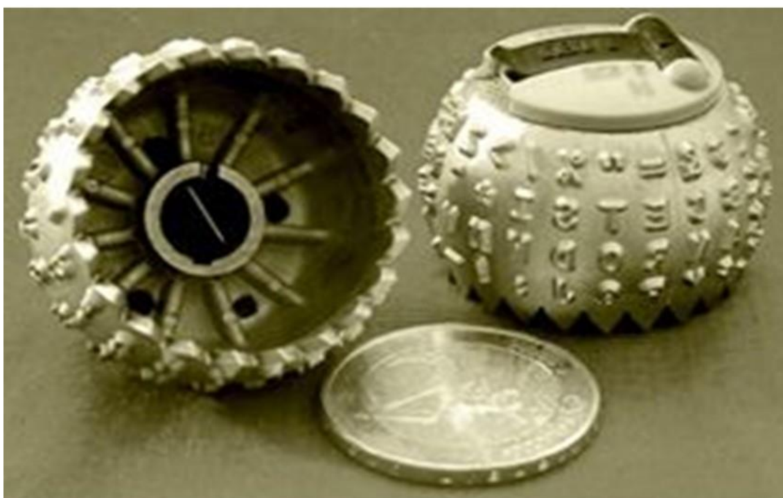
Një prej dhe një prej llojeve të kokave të shkrimit të makinës së markës "IBM Electronic Selectric Composer." (Madhësia e kokës krahasuar me monedhën prej 2 euro)
